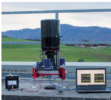
Die Zenitkamera CODIAC von swisstopo ist mit einer Genauigkeit der Lotabweichung von ungefähr 0,05 Bogensekunden weltweit eines der genauesten Instrumente zur Berechnung des Geoids.
