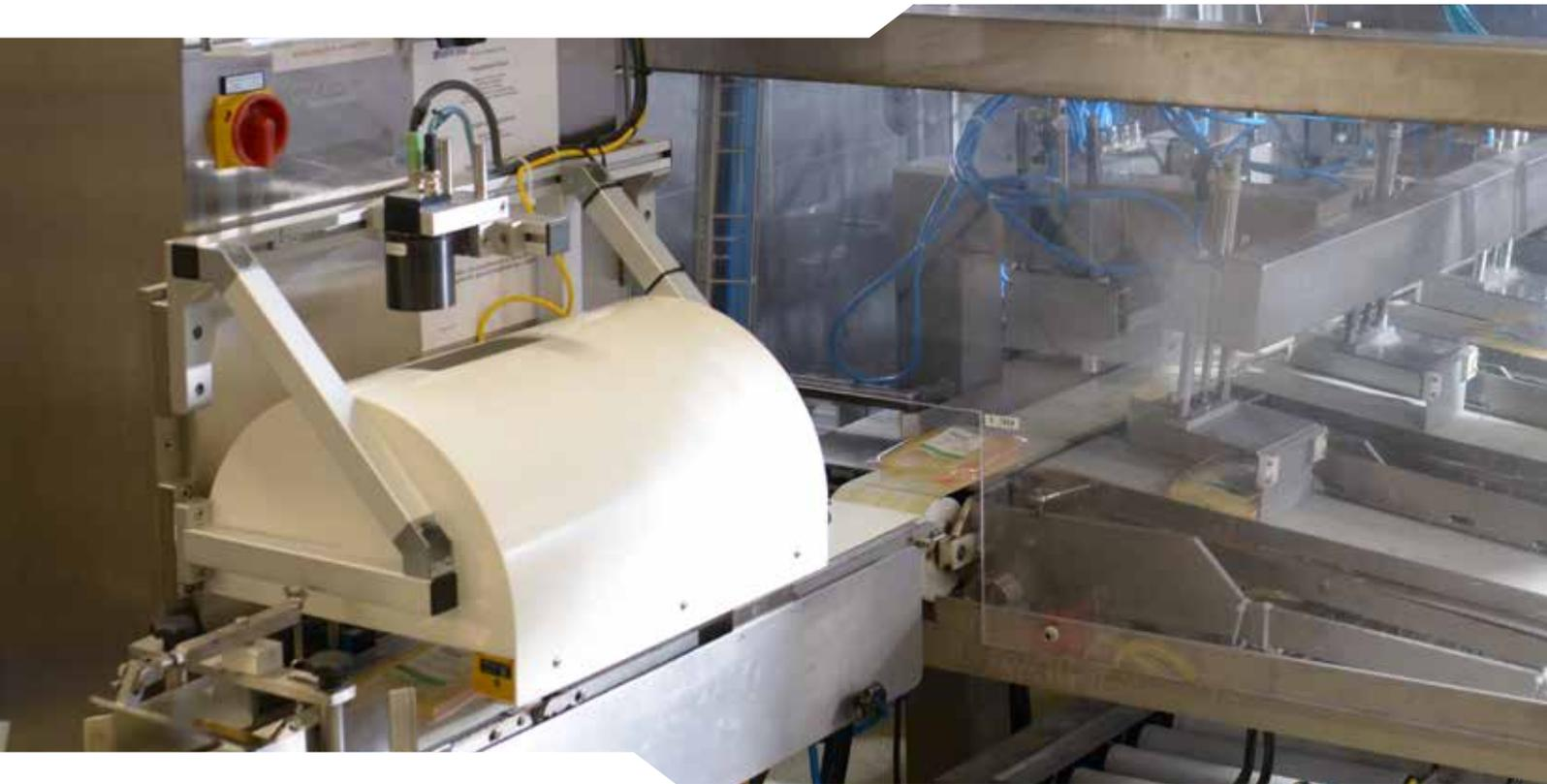
mettent un développement plus simple et plus rapide de l'ensemble du système. M. Graf ajoute que ces caméras prennent en charge le concept du «Safe Trigger», qui permet de se libérer des interférences sur le signal du Trigger. Cette fonctionnalité accélère particulièrement le développement du système pour l'utilisateur.
