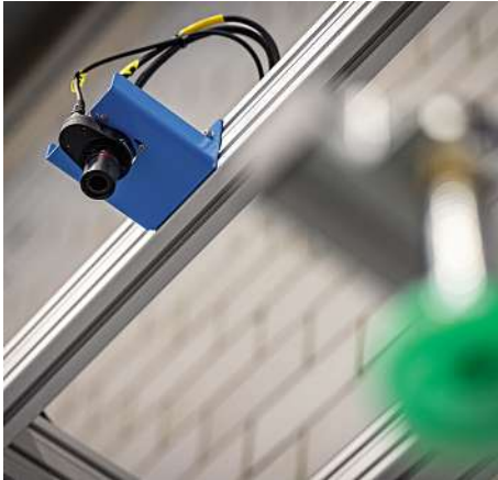
Das Bildverarbeitungssystem ist über der Anlage montiert.
